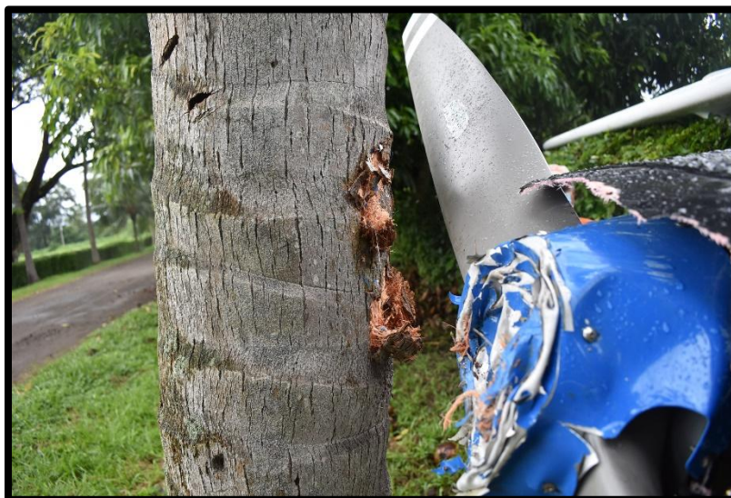
Fotografía No. 4 Condición de la forma en que quedó el Speener de la hélice.
