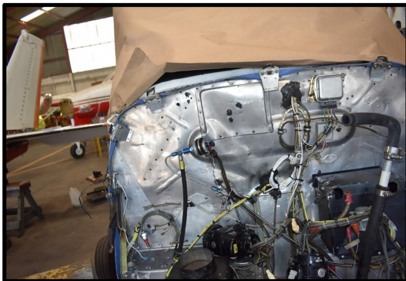
Fotografía No. 11 Vista de la pared de fuego con daños (corrugada).
